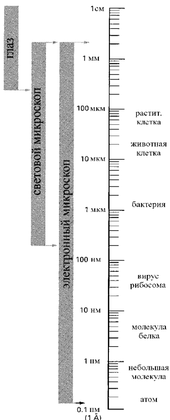
Рис. 3.1. Сравнение возможностей человеческого глаза и микроскопической техники с разной степенью разрешения.
